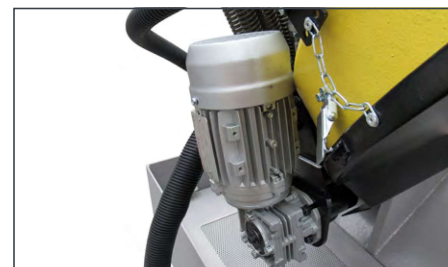
Spazzola motorizzata. Blade cleaning motorized brush.
