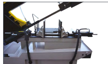
Morsa autocentrante. Self-centring vice.
